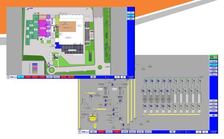
che da impegnare nei vari passaggi. Tra le funzionalità del sistema vi sono anche quelle che attengono al monitoraggio dei sistemi di pesatura, che rilevano la quantità di materiale che viaggia tra le varie parti dell'impianto. Questa architettura consente di rilevare efficacemente e in modo univoco tutte le informazioni sui lotti di produzione, archiviandole nel database.
