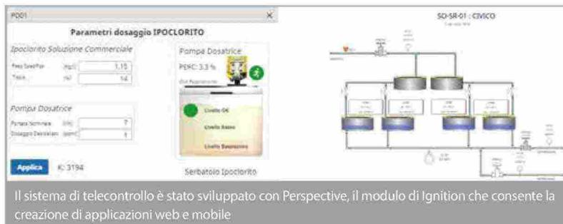
Il sistema di telecontrollo è stato sviluppato con Perspective, il modulo di Ignition che consente la creazione di applicazioni web e mobile
