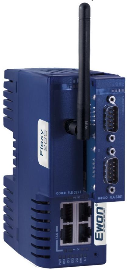
Tra i prodotti distribuiti da EFA c'è Ewon Flexy 205 di HMS Industrial Networks, il nuovo gateway IIoT con tecnologia MQTT pensato per le applicazioni della fabbrica connessa.
