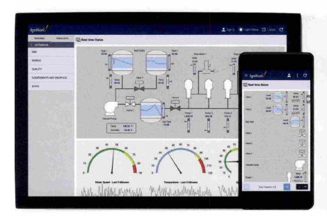
Italcanditi ha integrato in un'unica architettura di supervisory control 82mila tag e svariate migliaia di trend, implementando più progetti contemporaneamente per la gestione dell'intero impianto. Il sistema, centralizzato su un unico server, si avvale di 49 client
